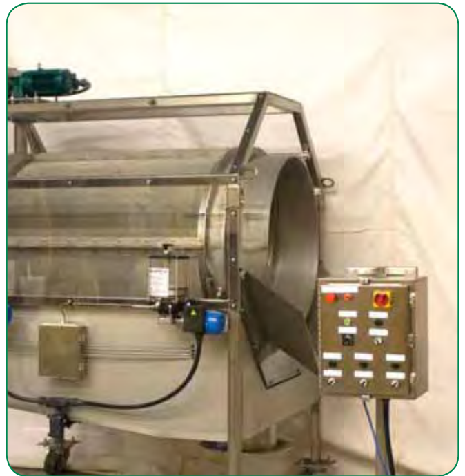
Барabanное сито Monster включает автоматизированный контроллер. JWCI предлагает дополнительную систему автоматической подачи смазки и привод с регулируемой частотой.
