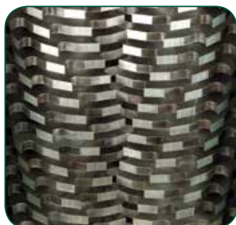
Двухвальный измельчитель. Стальные фрезы
