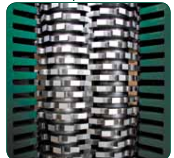
Эксклюзивно: боковые решетки для увеличения пропускной способности
